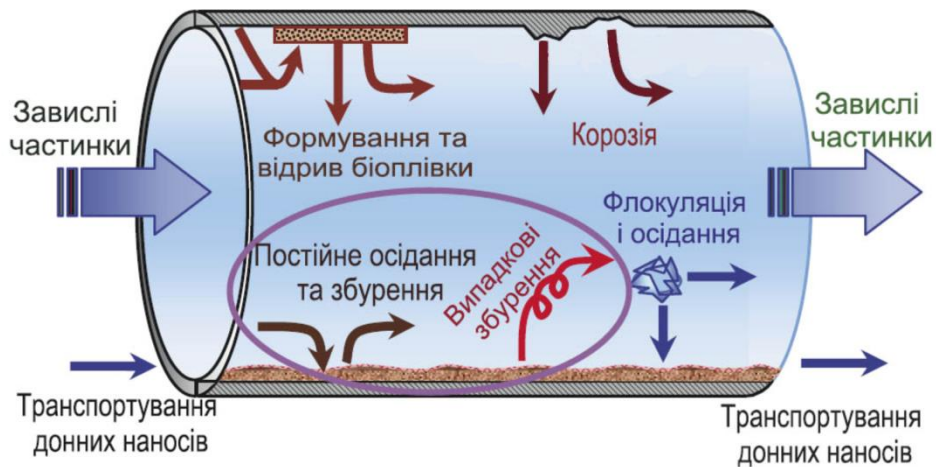
Рисунок 2.17. Модель формування біоплівки, корозійних процесів, флокуляції та осідання корозії
